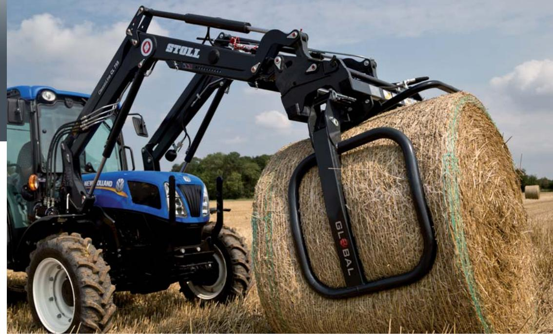
**Folienballenzange** – so bleiben Ihre Folienballen unbeschädigt. Die Folienballenzange hat keine scharfen Kanten und wurde speziell für den Transport und das Verladen von Folienballen entwickelt.
