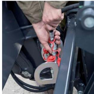
3 Kuppeln der hydraulischen Verbindung
