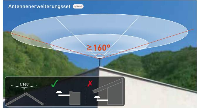
Sollte die im Lieferumfang enthaltene GNSS-Einheit nicht genügend Empfang erhalten, ist ein Antennenerweiterungsset erhältlich. Um ein besseres Signal zu erhalten, installieren Sie die Antenne an einer freien Fläche mit einer ungehinderten Sicht von mindestens 160° auf den Himmel.
