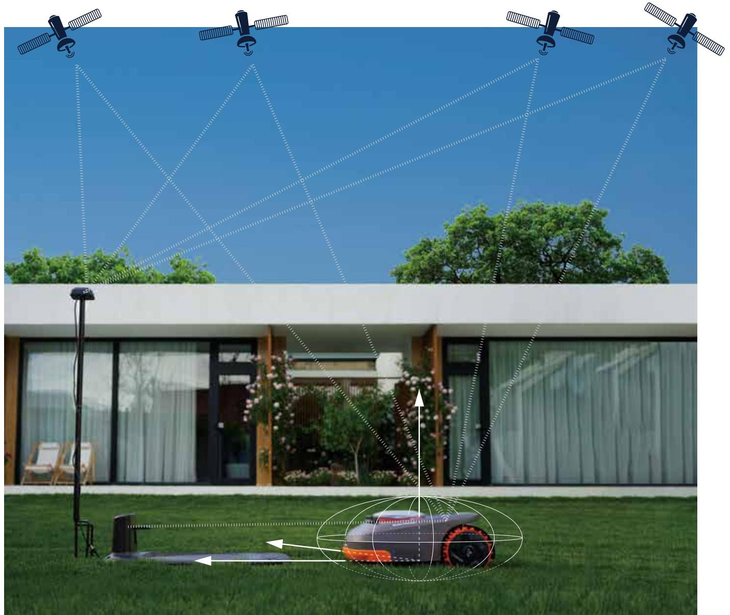
**WIE FUNKTIONIERT DAS EXACT FUSION LOCATING SYSTEM (EFLS)?** Mit dem Exact Fusion Locating System (EFLS) von Segway Navimow kann die virtuelle Begrenzung, basierend auf satellitengestützter Technologie mit einer Positionierungsgenauigkeit bis auf wenige Zentimeter genau angelegt werden, ohne dass ein Begrenzungskabel erforderlich ist.
